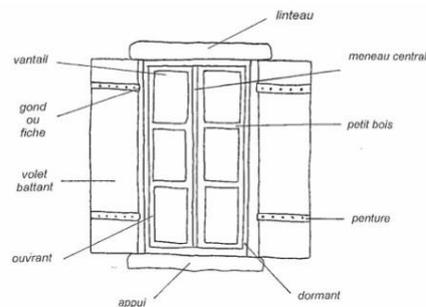
Dans le cas de projet de rénovation, les nouvelles menuiseries seront disposées dans les feuillures existantes des baies et non en surépaisseur du dormant ancien qui aurait été conservé. En cas de surépaisseur, cela peut conduire à ce que les profils soient épais aux proportions inesthétiques.
